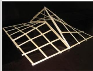
Der Workshop aus dem Themengebiet des Überspannens beinhaltet den Entwurf und das Bauen einer Tragkonstruktion als Raumabschluss (Decke, Dach) für eine Grundfläche von 60x60cm. Als Konstruktionselemente stehen jeder Gruppe Holzstäbe und Drahtseile zur Verfügung. In einem anschließenden Versuch werden alle Modelle hinsichtlich ihrer vertikalen Beanspruchbarkeit bis zum Bruch belastet.
